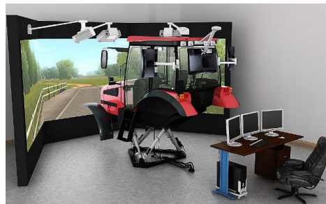
Рисунок 3 - Комплексный многофункциональный тренажер трактора МТЗ 1221
